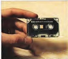
La cassetta di nastro magnetico e la sua impostazione nei tre compartimenti della periferica HP-82161.
